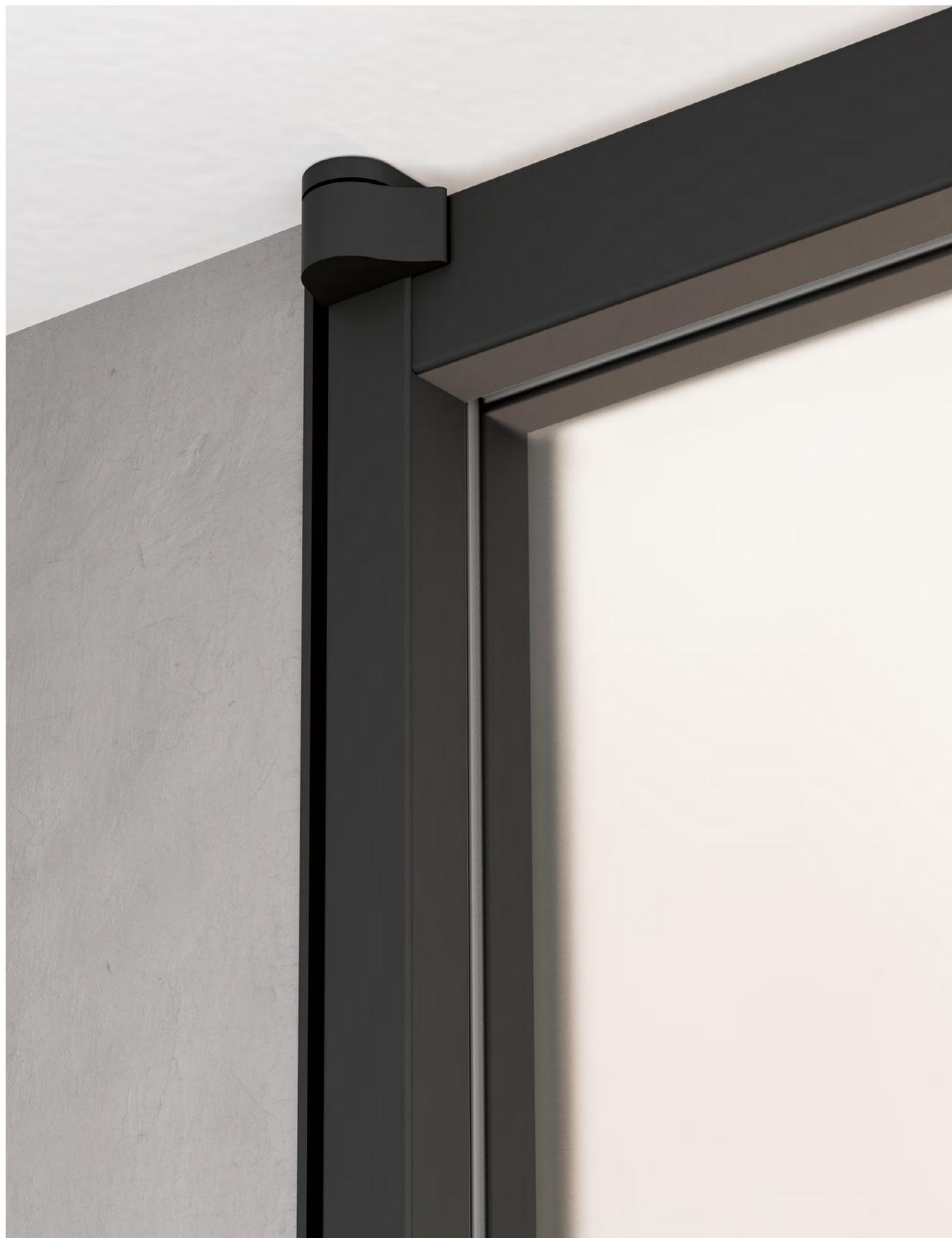
Алюминиевые полотна устанавливаются на торцевые петли, которые регулируются в трех плоскостях и выдерживают нагрузку до 60 кг. Благодаря своей конструкции, они практически невидимы и обеспечивают открывание полотна на 180°. Врезка под петли выполнена на высокоточном оборудовании, что существенно сокращает время монтажа.
